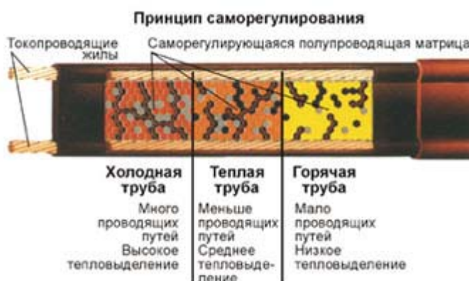
Рис.4. Принцип работы саморегулирующейся тепловыделяющей матрицы.
