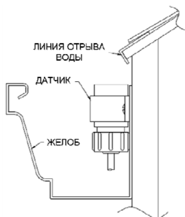
Рис.4. Крепление датчика влажности в желобе
